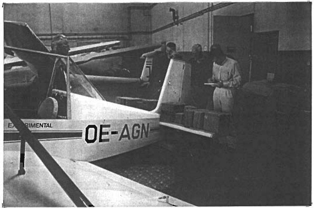
Belastung pro Leitwerkseite 110 kg
