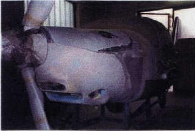
Das Laminieren ging dann schon recht flott von der Hand – kein Wunder bei einigen hundert Stunden Übung. Schnell waren auch die kleineren Übungen wie Kühlluftklappe, Schaulochdeckel und Schutzgitter gefertigt und montiert sodaß Andreas endlich an die Ausführung seiner lang gehegten Idee – der Anbringung eines Haifischmaules – gehen konnte. Ich stand dieser Idee anfangs
