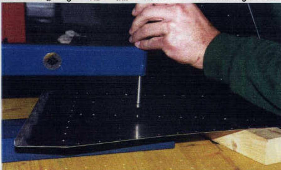
*Zum „Dimpeln“ muss ein eigenes Werkzeug verwendet werden*
