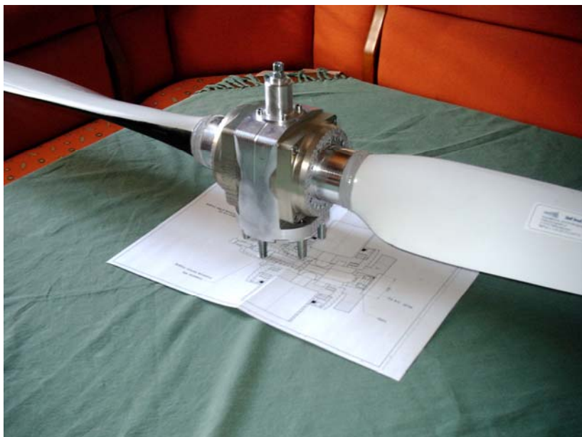
Der fertige Propeller in der Version mit mechanischem Antrieb. In der Glocke oben können die Endstellungen für kleinste und größte Steigung eingestellt werden
