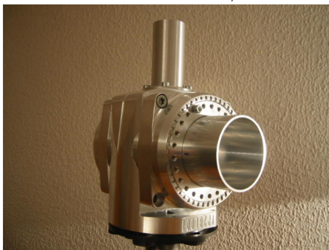
Der erste Prototyp der Verstellnabe. Der zylindrische Aufsatz oben nimmt den Getriebemotor auf. Die Verzahnung im Gehäuse dient zur Feineinstellung des Lagerspiels der Propellerblätter.
