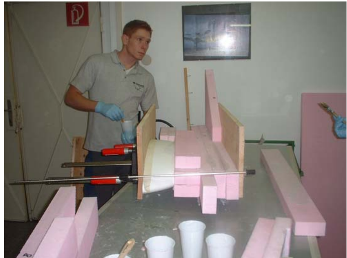
Aufkleben von Styrodurklötzen, aus denen dann die neue Randbogenform herausgeschliffen wird
