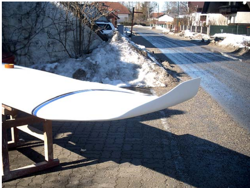
Das fertige Urmodell des neuen Randbogens bereits provisorisch auf die Cherryflügel aufgeklebt
