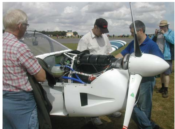
Beim obligaten PFA Treffen in Kemble war der englische Wilksch Dreizylinder Zweitaktmotor bereits in einem Flugzeug eingebaut zu sehen.
