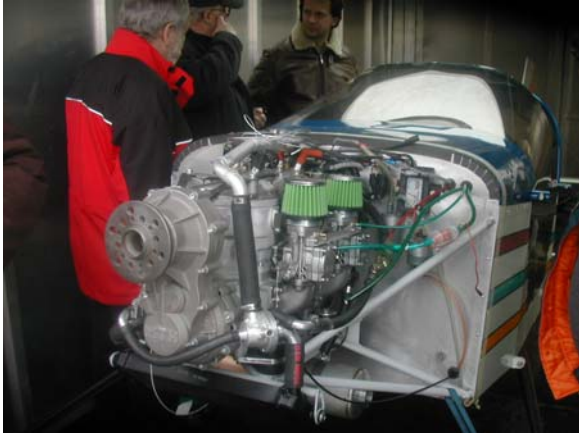
Bei der Jahreshauptversammlung stellte Josef Hattinger seinen neuen Zweizylindermotor mit 100 PS vor
