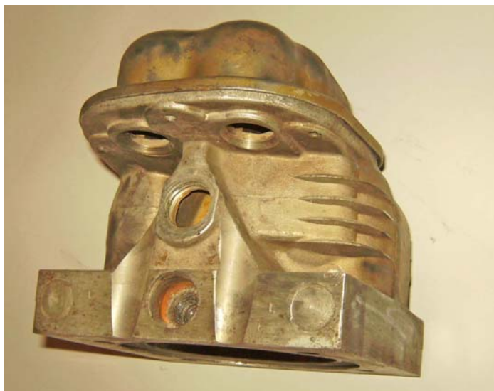
Der wassergekühlte Zylinderkopf, das eigentliche Kernstück der Idee von Oskar Westermayer
