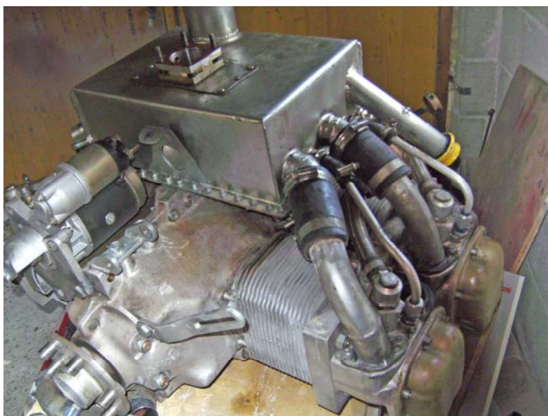
Der Motor nach der Übernahme: Vergaser, Generator und Anlasserzahnkranz fehlen, sonst ist alles da.
