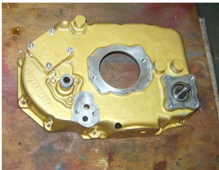
Der Geräteträger fertig lackiert und die neue Wasserpumpenwelle bereits eingebaut
