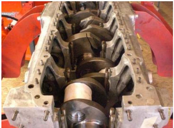
Die neu geschliffene Kurbelwelle im Motorblock
