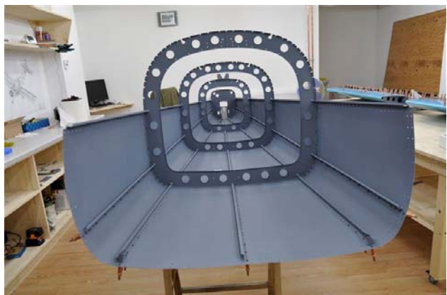
Der Rumpf der RV-12 wird ohne Helling gebaut
