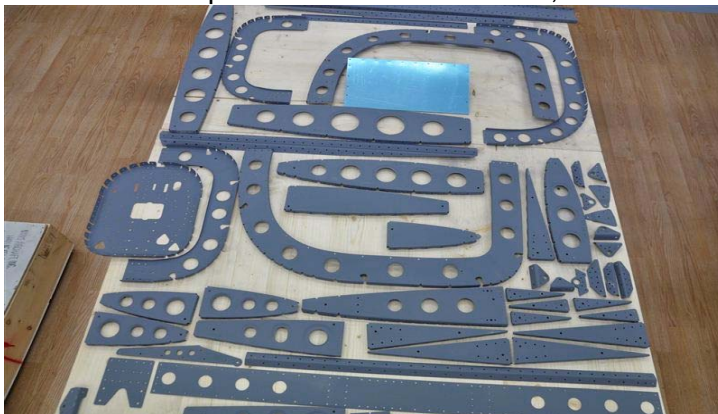
Alle Teile müssen zuerst geprimert werden
