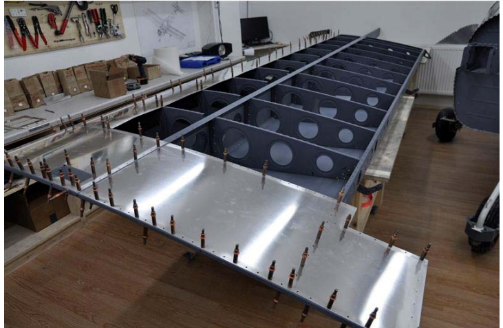
Beplanken des Flügel skeletts. Die Bleche werden vorerst mit Clecos (Heftnadeln) fixiert
