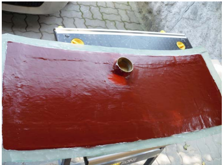
Die Tankoberseite vor dem Aufkleben. Am Rand die unbeschichtete Klebelippe
