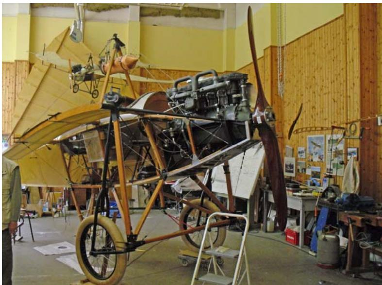
*Ein 160 PS Ranger Motor und ein Wolf-Propeller sorgen für den nötigen Vortrieb*
