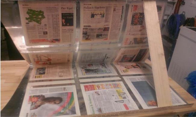
Ruderbeplankung abgeklebt und fertig fürs Grundieren
