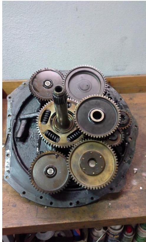
Der Motor wird über einen Schwungrad Anlasser gestartet. Das heißt, der relativ kleine Anlassermotor treibt eine Schwungmasse auf sehr hohe Drehzahl an. Wenn diese erreicht ist, wird über ein Untersetzungsgetriebe die Kurbelwelle eingekuppelt und die Energie der Schwungmasse setzt den schweren Motor in Bewegung. Nachdem die ersten Zylinder gezündet haben, wird wieder ausgekuppelt.
