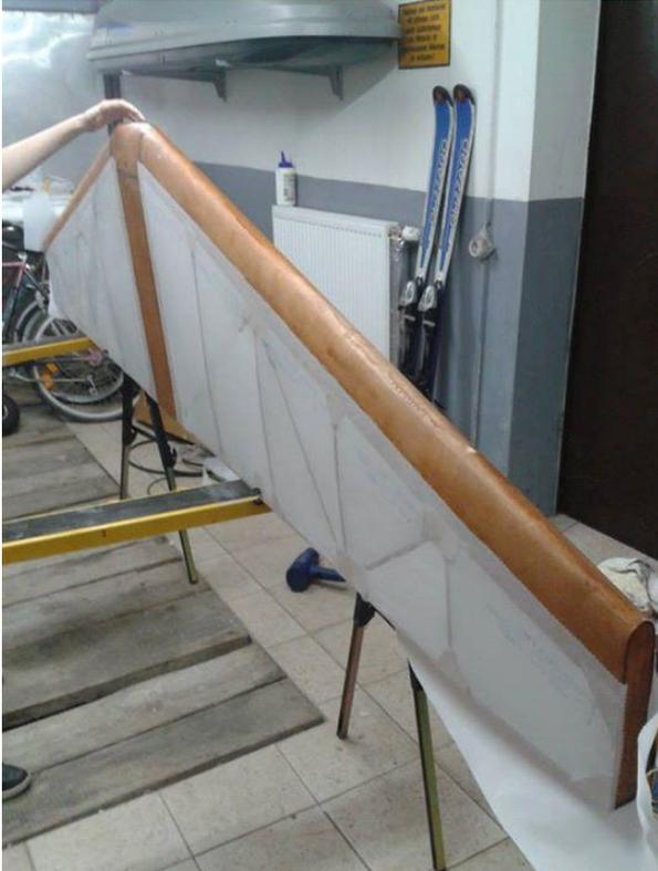
Rippen. Mit einer langen Alulatte mit groben Schleifpapier haben wir alle Rippen gleichgeschliffe. Beim Beplanken der Flügel griff uns ein Freund aus Tschechien mit sehr viel Erfahrung im Holzflugzeugbau unter die Arme. Dank ihm lernte ich sehr viel. Die Beplankung der Flügel wurde mittels Wasserdampf vorgebogen. Zur
