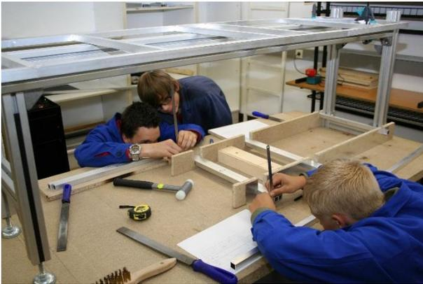
Schablonenbau: Um den Rahmen fertig zu stellen, bzw. ihn in seine endgültige Form zu bringen sind viele Vorarbeiten notwendig. Z.Bsp. mussten wie am Bild ersichtlich Schablonen hergestellt werden damit beim anschließenden Verschweißen Maß und Formgenauigkeiten beibehalten werden.
