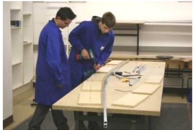
Nachdem die Pläne des Rahmens auf CAD neu gezeichnet wurden ging es an den Zuschnitt und Aufriss der Grundfläche des Rahmens. Das Biegens der der Formrohre erfolgte größtenteils durch Handarbeit. Der Formenbau basiert auf unterschiedlich dicken Spannplatten und verhindert beim bevorstehenden Schweißen ein „verziehen“.
