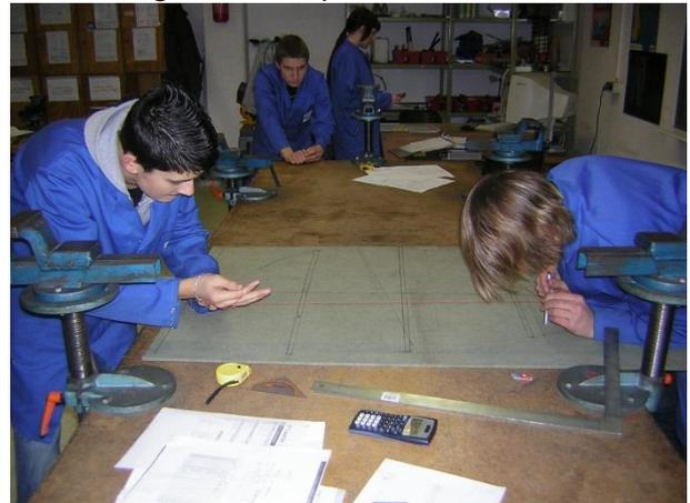
Es wurden Schablonen für das Höhenruder und Seitenruder im Maßstab 1:1 angefertigt um ein plangenaues Biegen der Formrohre sicher zu stellen.
