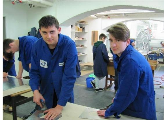
Die Fertigung der gänzlich aus Aluminium bestehenden Teile lief in einem perfekten Stationenbetrieb ab. Jede der fast 50 Rippen wurde an nur einem Tag zugeschnitten, vorgebohrt, entgratet, gekantet und geflutet. Im Frühjahr 2015 war ein Großteil aller Einzelteile hergestellt.
