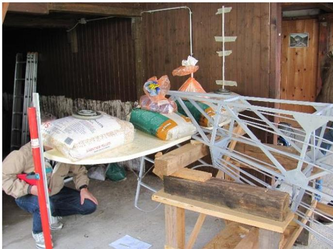
Nachdem die mehr als 1000 kg von der Unterseite der Flügel abgenommen wurden und es zu keiner bleibenden Verformung gekommen ist, wurde das Höhenleitwerk geprüft. Hierbei reichten die 25 kg und 15 kg Säcke aus, um ausreichende Lastannahmen simulieren zu können.
