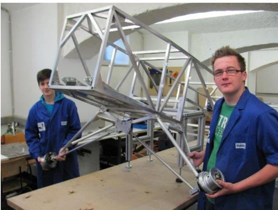
Das Schuljahr 2012/13 neigte sich schon dem Ende zu, trotzdem konnte noch das komplette Fahrwerk inklusive Spornradbefestigung fertig gestellt werden. M. Sovak half bei der Montage der scheibengebremsten Hauptfahrwerksräder. Damit die Fahrwerksgeometrie möglichst genau wird, mussten viele Einzelteile aufeinander abgestimmt werden.
