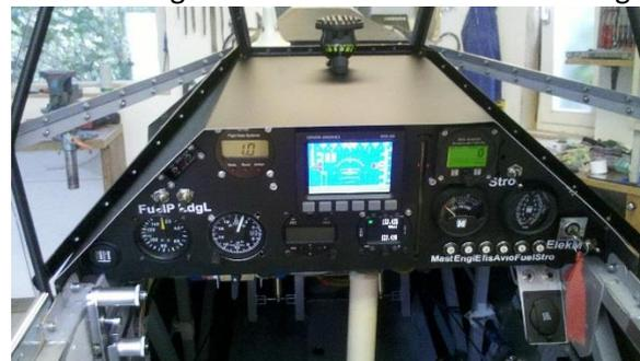
Nach Abschluss der elektrischen Arbeiten und bevor die letzten Bespannfolien am Rumpf angebracht wurden, konnte erstmals „bespannt“ werden. Speziellen Dank hierfür allen Mitarbeitern der Fa. Pauer aus St. Veit und meinem speziellen Freund R. Haimburger. Ob beim Pinlöten, Signalspannungsmessen oder bei der Propellerdrehzahlüberprüfung mit Hilfe einer Stroboskoplampe, ohne ihr Expertenwissen würde heute noch nicht alles richtig funktionieren.
