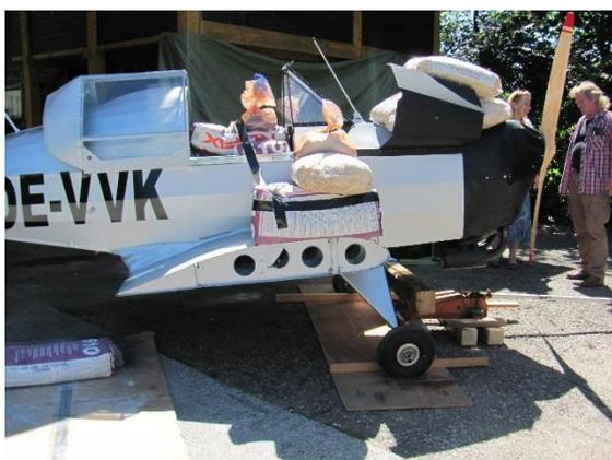
Noch einem weiteren Test musste die Pegasus standhalten. Beim Fahrwerkstest wurden zusätzlich zum höchstzulässigen Gesamtgewicht von 280 kg noch weitere 560 kg aufgelegt. Die Räder wurden hierbei gleitend gelagert, damit die Spurveränderung beim Einfedern ungehindert vonstatten gehen konnte. Auch dieser Test wurde bestanden, was für das bald bevorstehende erste Rollen ein sicheres Gefühl gab.
