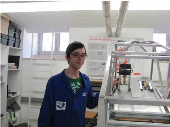
H. Karim präsentiert auf diesem Bild den verbauten Boden mit eingebauten, hydraulisch gesteuerten Zehenspitzenbremsen. Wie schon beim Leitwerk, wurde auch hier jede Nietung zusätzlich verklebt.
