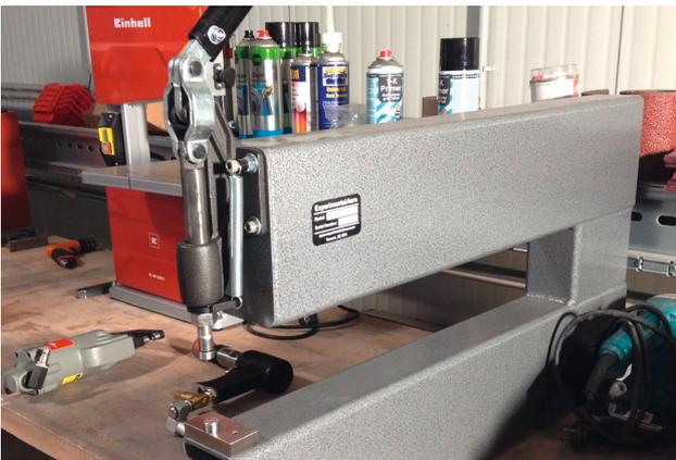
Für den Aufbau des Tailcones ist keine Helling notwendig, es genügt ein ebener, stabiler Tisch. Vor dem Zusammenbau werden die Teile entgratet, gedimpelt (Senkung für die Nieten gedrückt) und geprimert. Fallweise muss noch „geflutet“ werden, das heißt die durch das Tiefziehen verbogenen Teile müssen mit
