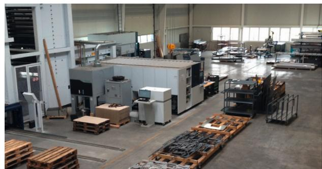
Systron hat man diesen Bedarf erkannt und Maschinen entwickelt, die Glastafeln bis zu 3,3 x 6 Meter Größe bearbeiten können. Die Bearbeitung erfolgt durch Schleifen der Ränder mit speziellen selbst entwickelten Schleifvorrichtungen und Wasserstrahlschneidern für die Ausschnitte und Ausnehmungen.
