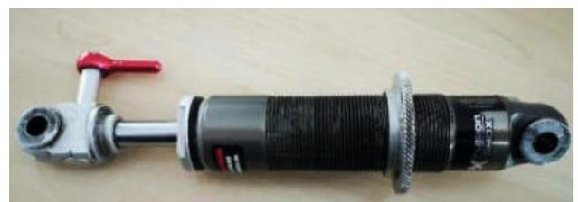
Bei der Pulsar verbauter Dämpfer mit entfernter Feder
