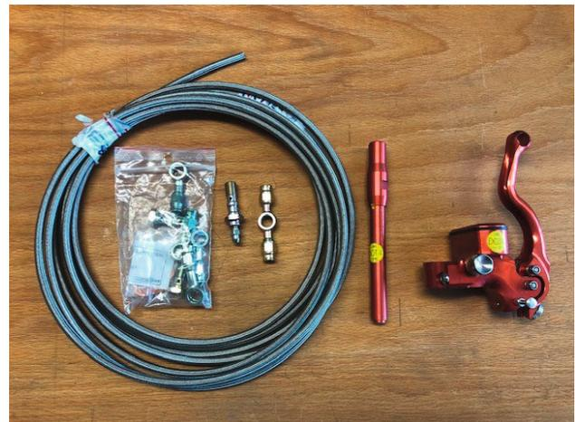
1 Handbremsgriff Beringer für hydraulisches Bremssystem mit DOT 4 Bremsflüssigkeit, Parkbremse am Handbremsgriff verriegelbar, Kraftlimiter einstellbar (um Blockieren der Räder zu verhindern), Bremsleitung Stahlflex ca. 3 m, Anschlussfittinge. Neu, unbenutzt. EUR 200,- statt Neupreis EUR 480,-
