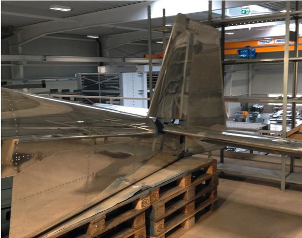
den alle Möglichkeiten des Nietens, das Setzen von Scharnieren usw. geübt. Natürlich sollte man auch noch an verschiedenen Blechabfällen den Umgang vor allem mit der Niettechnik üben. Ein Ausrutscher mit der Nietpistole oder dem Gegengewicht erzeugt hässliche Dellen, die nicht wieder ausgeklopft werden können.
