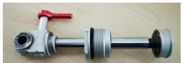
Kolbenstange mit Kolben demontiert (Teile A + D aus der Prinzipskizze) – das Teil mit dem Gewinde in der Mitte ist der Deckel des Kolbens.
