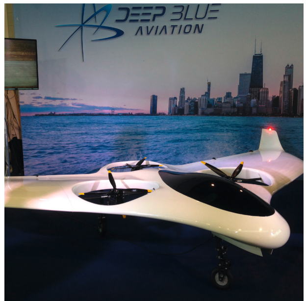
Silhouette nennt sich der Nurflügler, der von einem Unternehmen in Kufstein entwickelt wird. In der Version für zwei Personen soll die Spannweite 10,5 m betragen, bei 6-8 Insassen sind es 17 m. Bei Start und Landung können die äußeren Teile der Flügel hochgeklappt werden.
