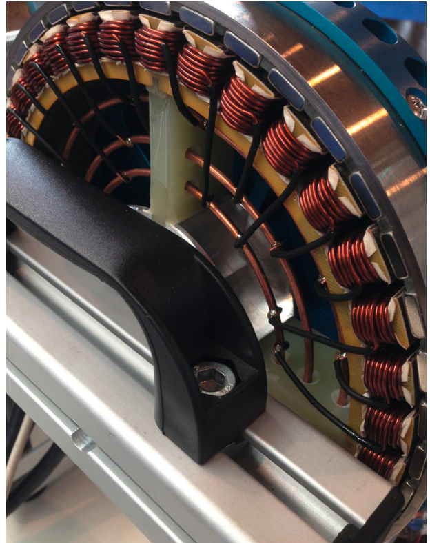
An diesem Modell sieht man, wie einfach kräftige Elektromotoren für Flugzeuge aufgebaut sind - zumindest mechanisch.
