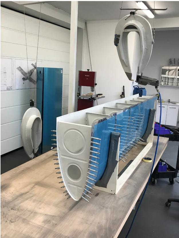
Nieten der Flügeltanks mit Spezialwerkzeugen der Marke Eigenbau
