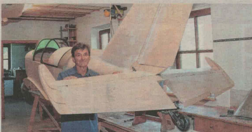
Helmut Hadinger mit seinem Holzflieger. Die Spannweite beträgt 6,10 Meter, die Geschwindigkeit bis zu 340 km/h.
