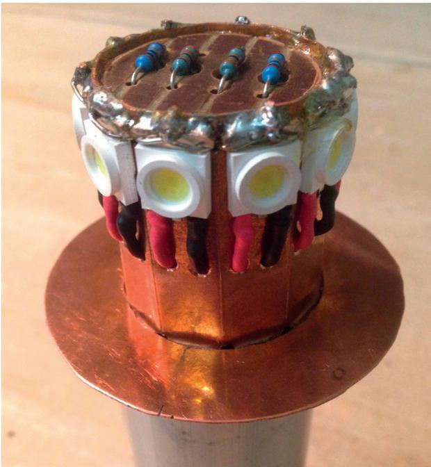
Abschließend verbinde man die Platine testeshalber mit dem neuen Blitzlicht. Dazu braucht man drei Leitungen, aber die sind im Flugzeug ohnedies vorhanden, weil der ehemalige Blitz ebenfalls mit drei Leitungen angespeist worden ist. Nun kann man die zwei LED-Fünfergruppen in verschiedenen Betriebszuständen leuchten lassen, entweder alle zugleich oder abwechselnd blinkend, in verschiedenen
