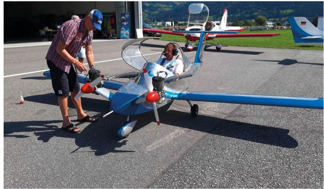
Gestartet werden die Motoren der Cricri von einem Helfer per Hand mit Seilzug
