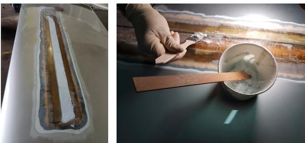
Die Rippenstruktur zum Fahrwerksschacht wurde fachgerecht rekonstruiert, Lage für Lage aufgebaut, sodass die Stabilität der Tragfläche wieder hergestellt ist.
