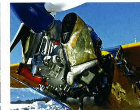
Auch beim Getriebe handelt es sich um eine Eigenentwicklung. Bei Vollgas dreht der 1,92 m große Dreiblatt-Verstellprop mit 2100 Umdrehungen.
