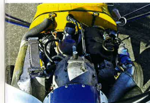
Der 1,9 Liter große VW-Dieselmotor ist um 30 Grad geneigt eingebaut. Links der große „Wasserkühler“, rechts der Ladeluftkühler.
