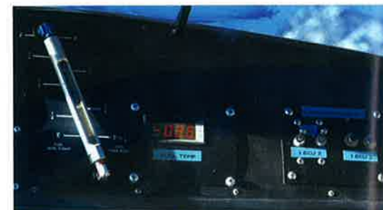
Ein Kombiinstrument informiert über Leistungsprozentwert, Propdrehzahl, Verbrauch und „Wassertemperatur“.
