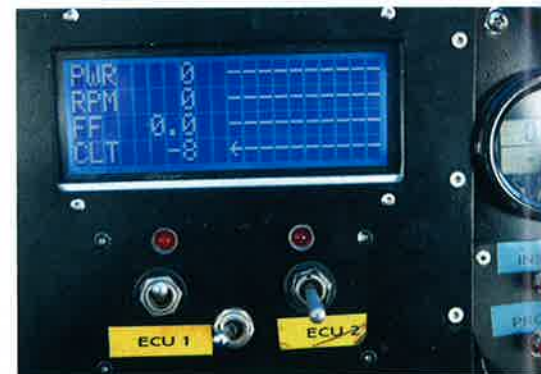
Ein Kombiinstrument informiert über Leistungsprozentwert, Propdrehzahl, Verbrauch und „Wassertemperatur“.
