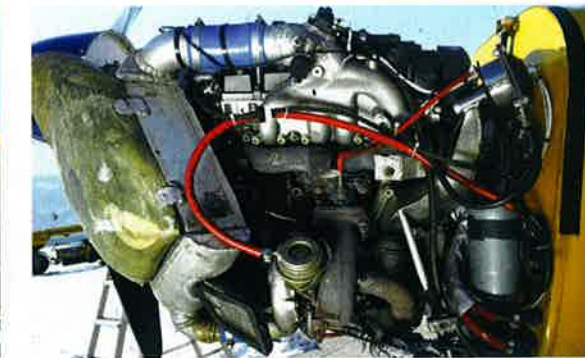
Dank Turbolader (Mitte unten) hält der Reihenvierzylinder bis 10 000 ft Dichtehöhe volle 100 Prozent Leistung bereit.
